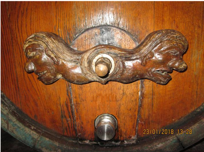
La clé de foudre est une pièce en bois, destinée à verrouiller la porte d'un gros tonneau. Elle se place par vissage en travers de l'ouverture, serrant ainsi le portillon contre la paroi frontale, afin d'obtenir une étanchéité parfaite. Ces clés peuvent être très simples, mais elles sont souvent également décoratives. Plusieurs motifs thématiques existent : outils de la vigne, agriculture, Bacchus, Dionysos, figures allégoriques etc.
