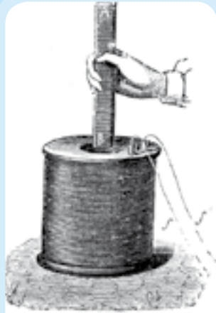
Fig. 248. — Induction par un aimant.
