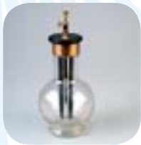
Pile de Grenet
